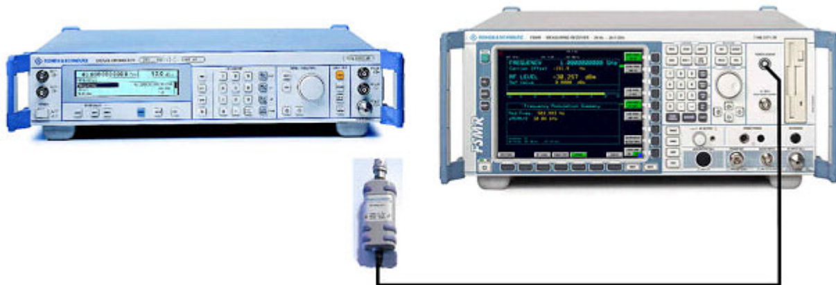
Bild 5-2 Aufbau für HF-Leistungsmessung
