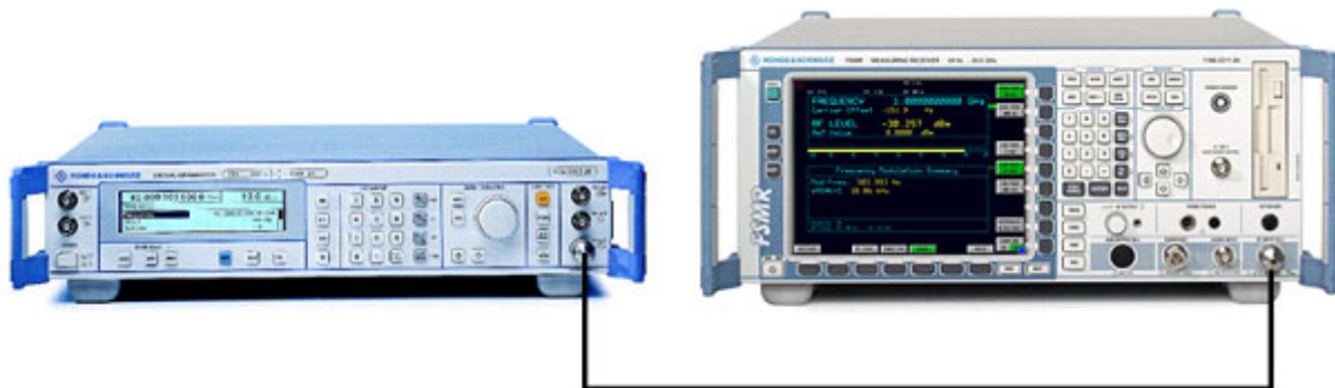
Bild 5-9 Aufbau für AM-Modulationsmessung
