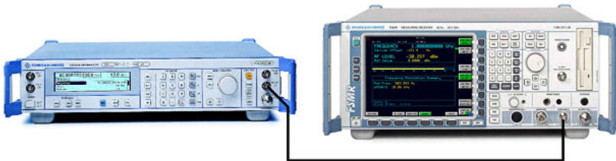
Bild 5-13 Aufbau für Audiomessung
