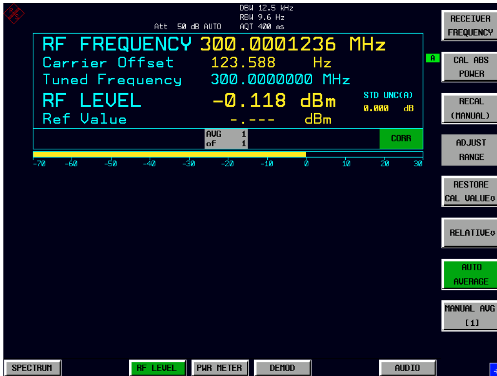
Bild 5-6 Selektive HF-Pegelmessung nach Kalibrierung
