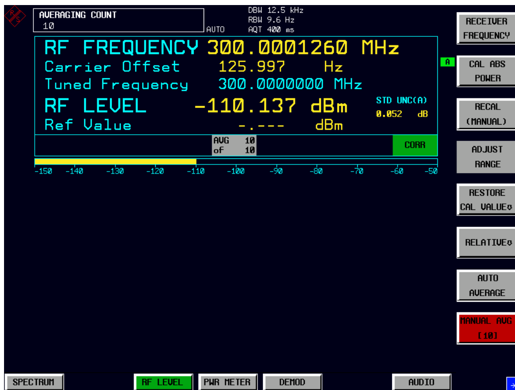
Bild 5-8 Selektive HF-Pegelmessung mit Mittelwertbildung
