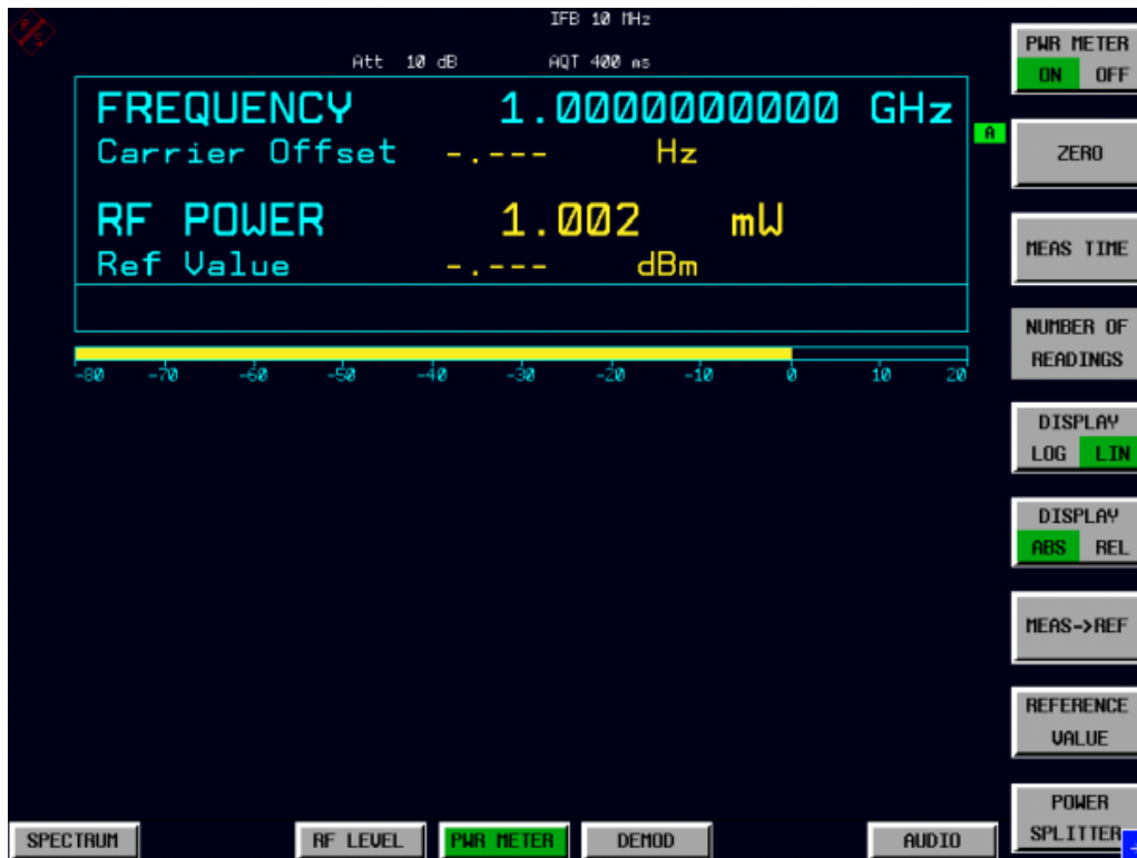
Bild 5-4 HF-Leistungsmessung in Watt
